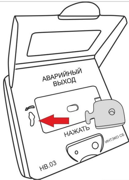
Для приведения извещателя в исходное состояние после срабатывания вставьте ключ в отверстие, расположенное слева на лицевой части корпуса под прозрачной крышкой. Поверните ключ против часовой стрелки и извлеките.
